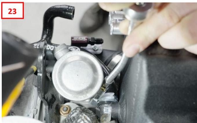
Befestigen Sie jetzt den Silikonschlauch 001004310 an der Chargepipe 001100045, benutzen Sie die Klemme D=20mm.(24)
