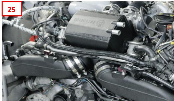
Befestigen Sie jetzt das Verbindungsrohr 001002517 an der Aufnahme vom Haubenschloss und benutzen Sie die Schrauben M6x25 + U-Scheibe 6mm. Schließen Sie jetzt die beiden Silikonschläuche 001004310 / 001004312 an, zum befestigen nehmen Sie die Klemme D=20mm. (26)
