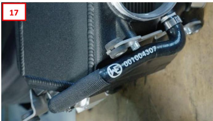
Setzen Sie jetzt den Ölabscheider auf den WT-LLK. **Achtung: Schauen Sie ob die Dichtung in der richtigen Position zwischen Ölabscheider und KGE Verteiler sitzt. Desweiteren müssen die beiden Kunststoffhaken sauber hinter dem KGE Verteiler einrasten.** (18,19)
