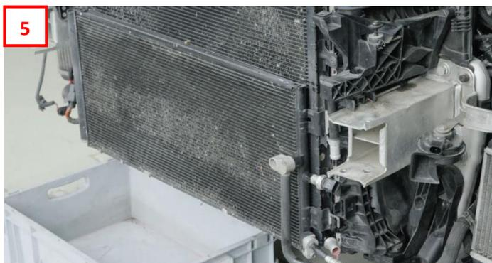
Demontieren Sie jetzt die oberen Schrauben am Kühlerträger. Lösen Sie die Schläuche die sich am Kühlerpaket befinden (Nieder-/Hochtemperaturkühler). Jetzt kann das gesamte Kühlerpaket (NICHT KLIMAKONDENSATOR) nach vorn entnommen werden.
