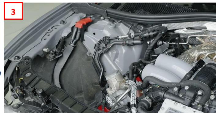
Lösen Sie unterhalb am Schlossträger auf der Innenseite die beiden Schraube L-R. Demontieren Sie die Sicherungsschrauben, mit dem das Kühlerpaket im Kühlerträger unten befestigt ist.(4)
