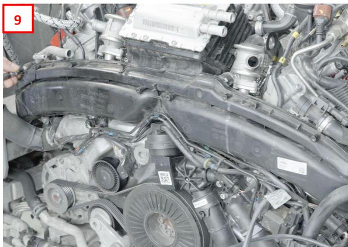
Lösen Sie jetzt die vier Schrauben seitlich vom Ladeluftkühler. Jetzt kann der Ladeluftkühler inklusive den Ölabscheider nach vorn entnommen werden.
