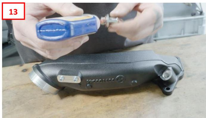
Beginnen Sie jetzt, mit der weiteren Vormontage des WT-Ladeluftkühlers 001001135. Nutzen Sie dafür neben dem WT-Teilen, den OEM Ölabscheider, Drosselklappendichtung und OEM-Map-Sensor. (14)
