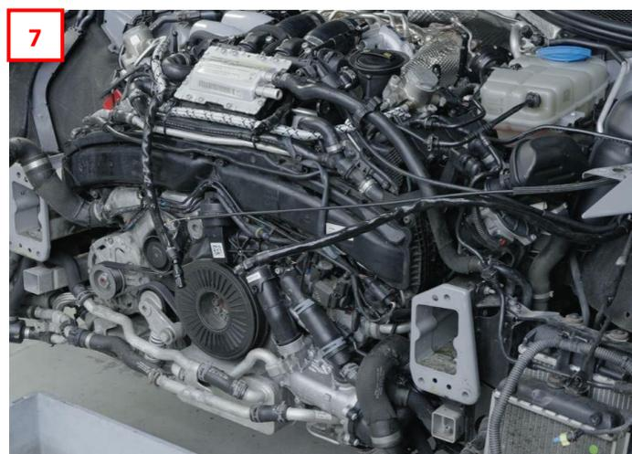
Entfernen Sie jetzt die Silikonschläuche samt Drosselklappe, zwischen Turbolader und OEM Ladeluftkühler.
