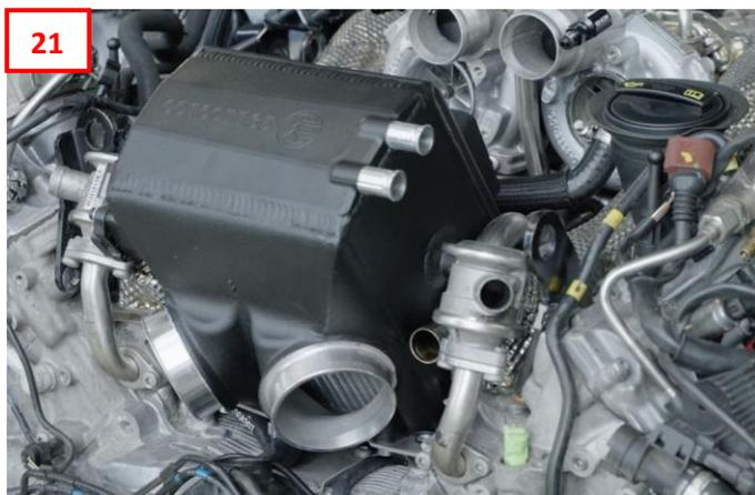
Montieren Sie die Chargepipe 001100044 / 001100045 zwischen WT-LLK und Ansaugbrücke, zum befestigen an der Ansaugbrücke, nutzen Sie dafür die **Schrauben M6x30** und die **Hülsen 001002533 + Scheiben 6mm**. Zur Verbindung am Ladeluftkühler nehmen Sie die mitgelieferten Silikonschläuche 001004306 und Schlauchschellen. (22)
